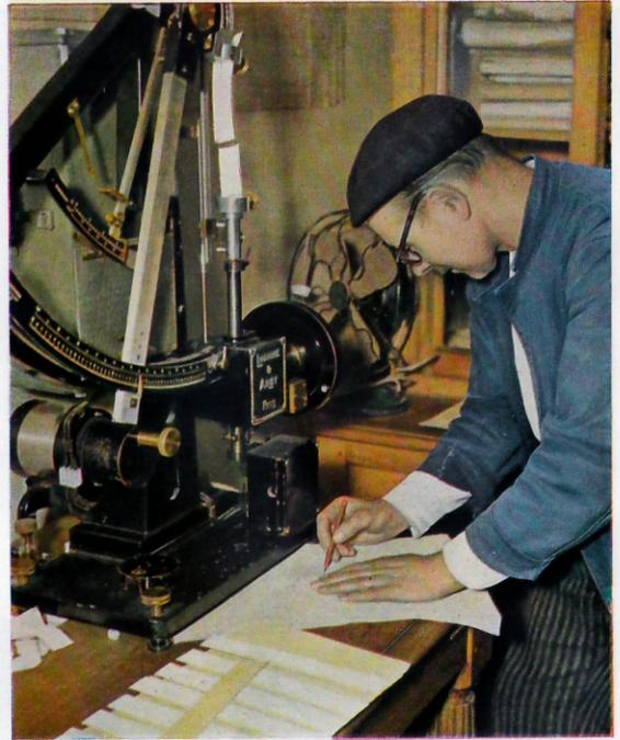
**LE DYNAMOMÈTRE** mesure la résistance à la traction et le pourcentage d'allongement du papier. Une bande de 33 millimètres de largeur doit résister à une traction supérieure à 3 kilos.
