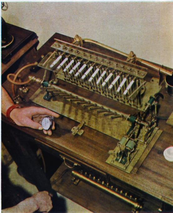
**LE " FUMEUR AUTOMATIQUE "** est un appareil inventé par un vieil ingénieur des usines et destiné à contrôler la durée de la combustion de la cigarette en fonction de la qualité du papier.
