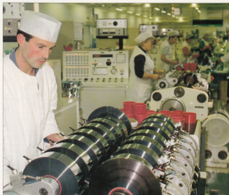
Le dernier bâtiment construit par Bolloré Technologies sur le site de Cascade en Seine abrite l'unité de métallisation. L'opération suppose un univers aseptisé : casques et blouses blanches sont de rigueur.
